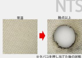
図4 PPSの温度による変化
