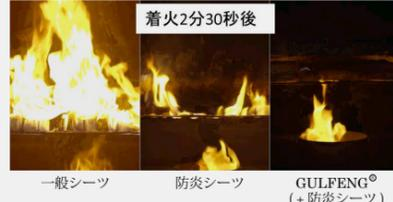
図11 燃焼挙動の比較
